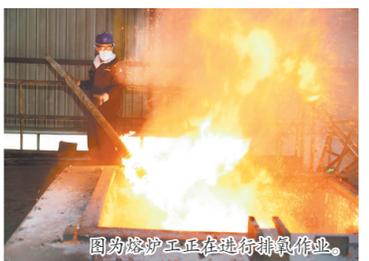
图为熔炉工正在进行排氧作业。
